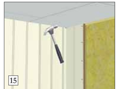
15) Platen spikres så i spikerleppen. Inne i hjørnet spikres platen synlig med dykkstift (håndspikring). Bunn og topp kan spikres på vanlig måte. Man bruker flikkmalingen (i org.fargen) til å male hodene på de synlige dykkstiftene. Bruk kosten som sitter i korken på flikkmalingsflasken (se bildet under).
